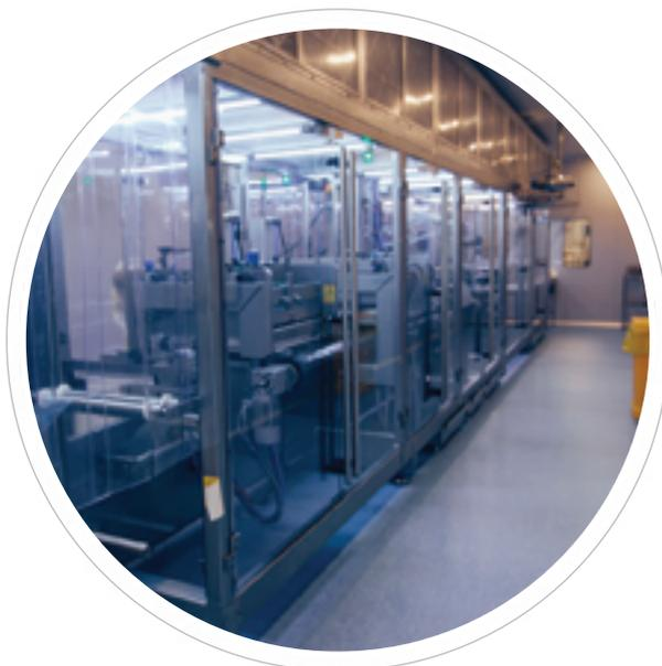
**04 – Línea automatizada alemana** de producción continua (formado/ llenado/ sellado de soluciones parenterales de gran volumen), que produce bolsas de 100 /250 /500 y 1000ml.
